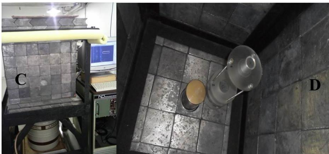
Figura 3.5 - Câmara de baixo fundo (C) e arranjo montado (D)
