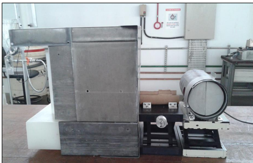
Figura 3.18 – Arranjo experimental de transmissão de nêutrons térmicos.
