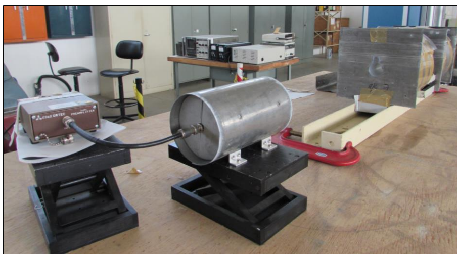
Figura 3.16 – Arranjo experimental de transmissão de nêutrons rápidos.
