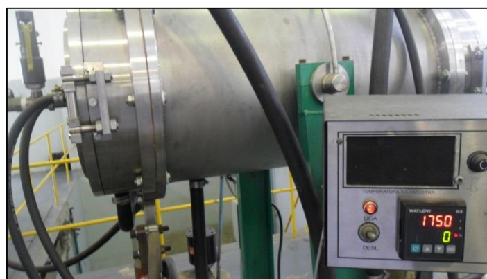
Figura 3.3 – Forno de atmosfera controlada utilizado na sinterização das cerâmicas.
