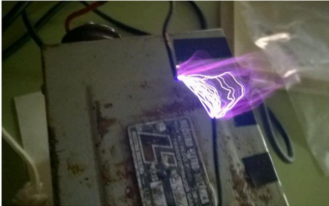
Figura 1 – O transformador e uma descarga entre os seus terminais quando há fluxo de ar lateral.
