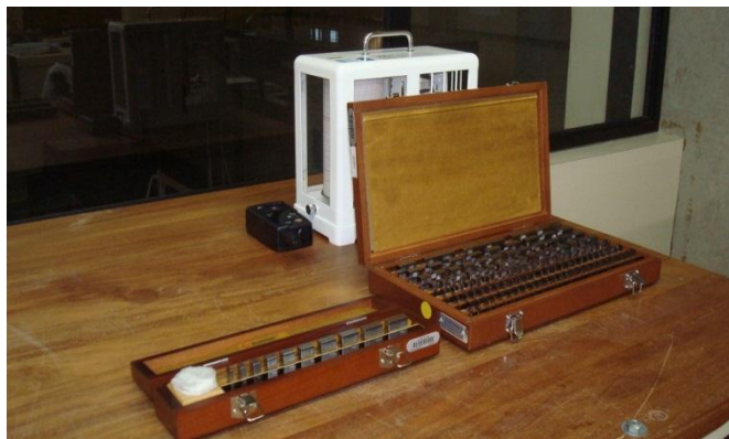
Figura 5 – padrões utilizados na calibração de paquímetros e micrômetros externos
