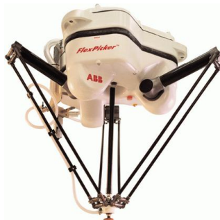
Figura B.13. Manipulador robótico do tipo paralelo.
