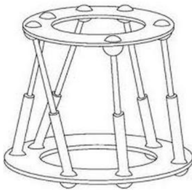
Figura B.14. Manipulador robótico do tipo paralelo, plataforma de Stewart.
