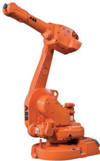
Figura B.12. Manipulador robótico do tipo serial.
