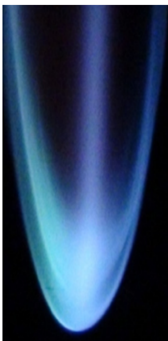
Figura 1.8 - Chama tripla com chama difusiva visualizada ao centro
