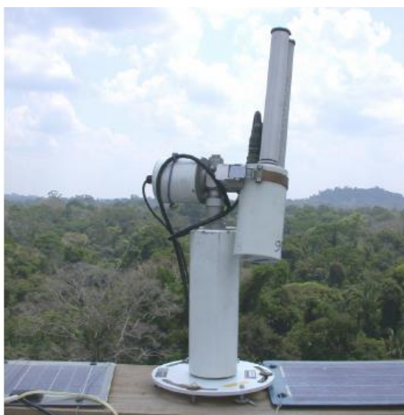
Figura 3.4 – Foto mostrando um radiômetro modelo 318-A em operação.
