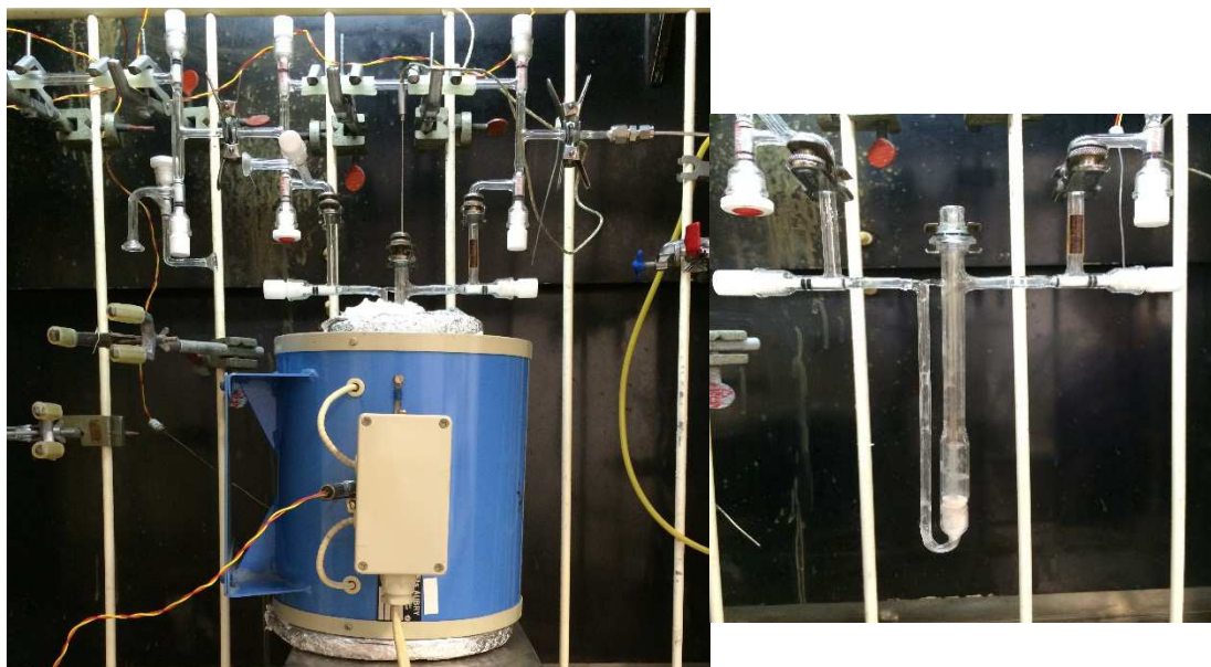
Figura 4.14 - Reator empregado na decomposição \text{NH}_3 (LCP/INPE).
