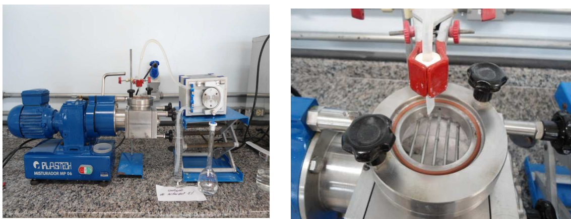
Figura 4.7 - Peptização: Misturador sigma e bomba peristáltica.
