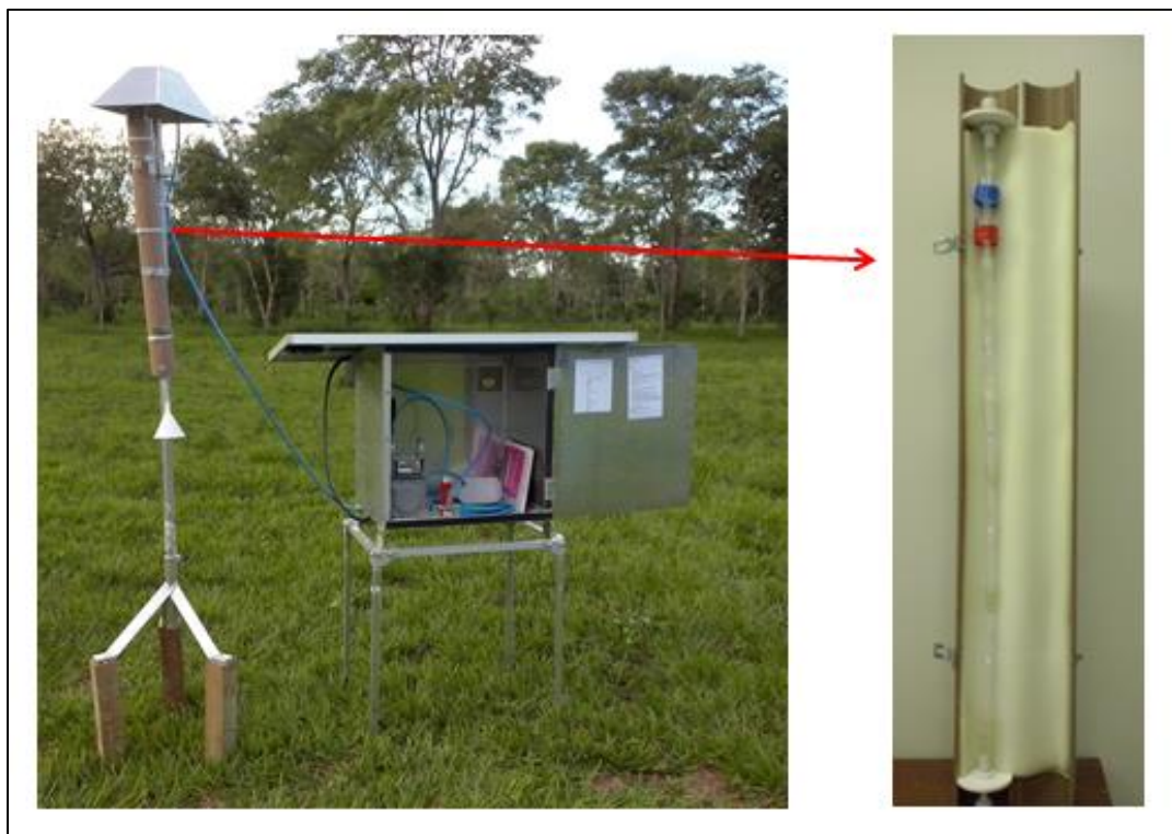
Figura 5: Sistema montado para coleta em campo e compartimento de PVC.
