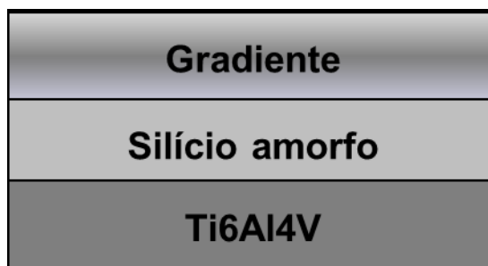
Figura 5.7 Esquema da composição das camadas no substrato.
