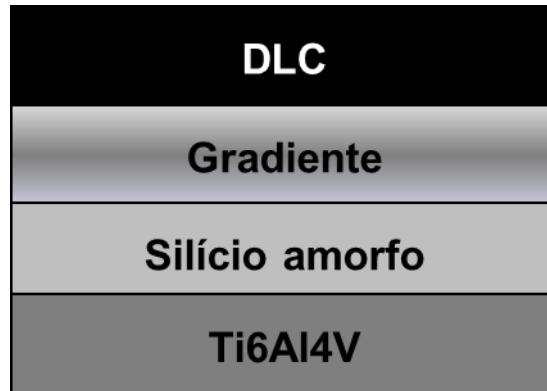
Figura 5.8 Esquema final da composição dos filme sobre o substrato.
