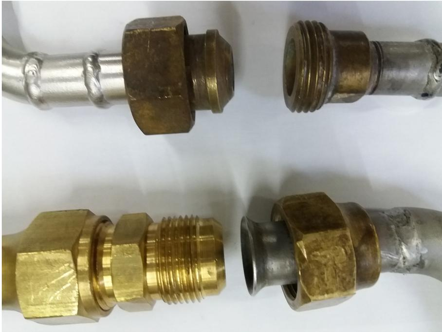
As conexões apresentadas aqui foram responsáveis por vazamentos durante o processo de transferência de líquido.
