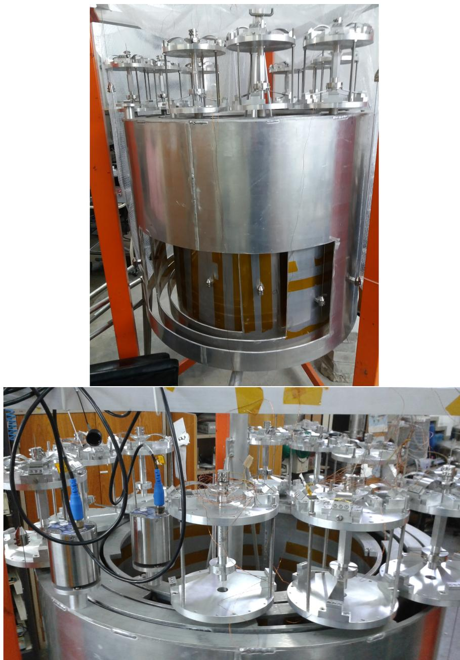
Na imagem superior desta figura é mostrado a versão atualizada do MNP, com as molas anti-geométricas substituindo as molas de gás, fios de aço (Music Wire) de 1 mm de diâmetro, cortes na seção para acesso aos estágios internos e suspensão pelo centro de percussão. Na imagem inferior, são vistos os sismômetros montados nos flanges superiores dos estágios mais externo e mais interno.
