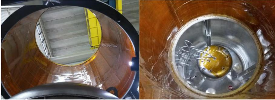
Serpentina recoberta com fita Kapton, visão inferior (à esquerda) e superior (direita).
