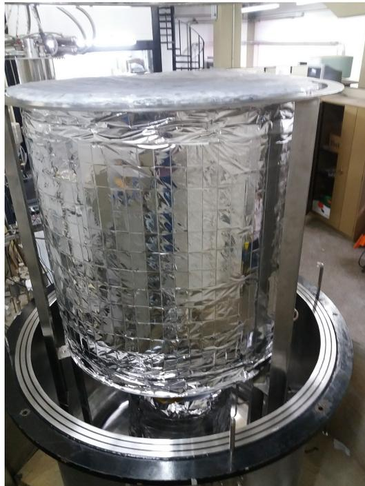
Neste isolamento existem camadas alternadas de *Mylar*<sup>®</sup> (filme de poliéster aluminizado) e uma tela de poliéster.
