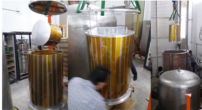
Processo mostrando três etapas do processo de montagem do experimento dentro da câmara. Massa de teste sendo colocada dentro da casca cilíndrica (à esquerda), estágio montado sendo içado pela ponte rolante (meio) e estágio sendo depositado dentro da câmara (à direita).
