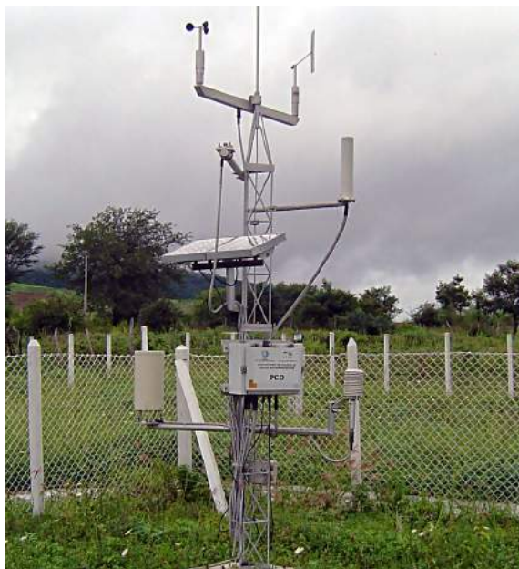
Figura 28. Estação automática de coleta de dados.
