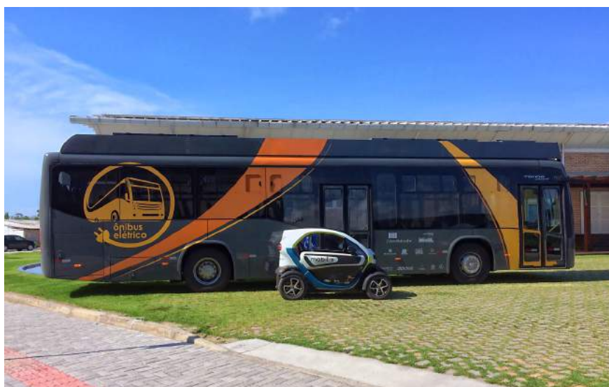
Figura 62. Ônibus elétrico e veículo elétrico de pequeno porte, ambos dotados de baterias de íons de lítio e alimentados por energia solar fotovoltaica.
