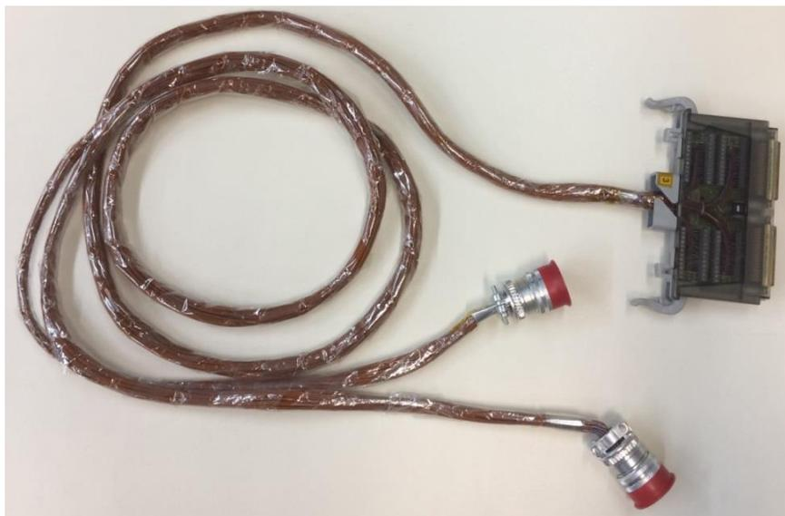
Figura 2 – Slot com cabeamento de cobre e constatam para medidas de termopares do tipo “T”.
